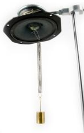
Obr. 5 Reprodukční, pružina a závaží – při rezonanci dochází k max. vybuzení
