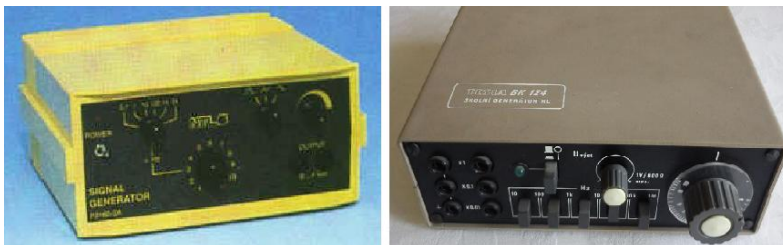
Obr. 1 Generátor funkcí od NTL a TESLA BK 124
