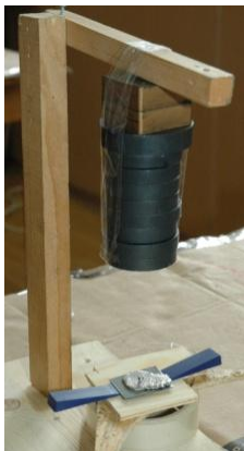
Obr. 5 Uspořádání experimentu a detail vznášejícího se magnetu
