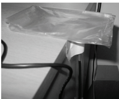
Obr. 4. Vlevo uchycení luxmetru ke hraně stolu pomocí papírové lepicí pásky. Vpravo stínění čidla pomocí několika vrstev igelitu vzniklých překládáním sáčku
