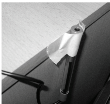
Obr. 4. Vlevo uchycení luxmetru ke hraně stolu pomocí papírové lepicí pásky. Vpravo stínění čidla pomocí několika vrstev igelitu vzniklých překládáním sáčku
