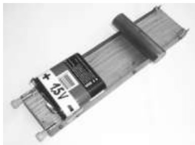
Obr. 6 Válec s magnety na kolejničkách z měděných pásků
