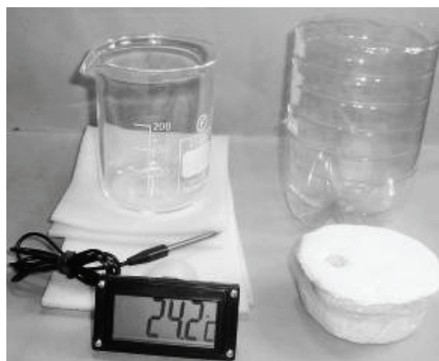
Obr. 4: Díly ke složení kalorimetru. Digitální teploměr není nutný, ale moc dobrý. Je mechanicky odolný a dostatečně citlivý.
