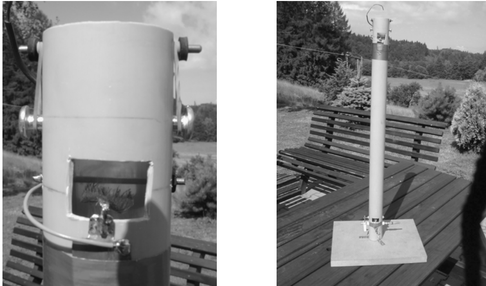
Obr. 2: Detail elektrod a celkový pohled na Van de Graaffův generátor bez konduktoru.
