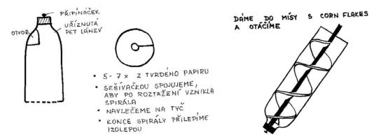
Image explanations: připínáček – drawing pin, otvor – hole, uříznutá PET láhev – cut off plastic bottle, z tvrdého papíru – from cardboard, sešívačkou spojujeme ... - fix together with a stapler to create a screw after being pulled, navlečeme na tyč – put onto the stick, konce spirály přilepíme izolepou – fix the ends of the screw by sticky tape
