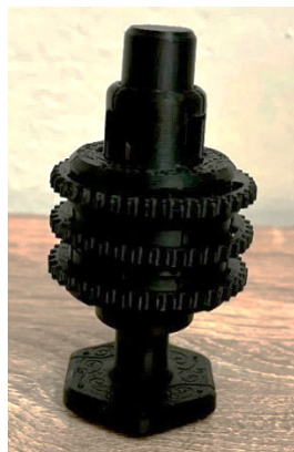
Obr. 10. Sestavený spínač pro stavebnici Spintronics.
