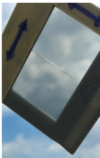
Obr. 8. Maximální pozorovaný kontrast při řídké oblačnosti. Slunce je s velkou nejistotou určení ve směru levé šipky.
