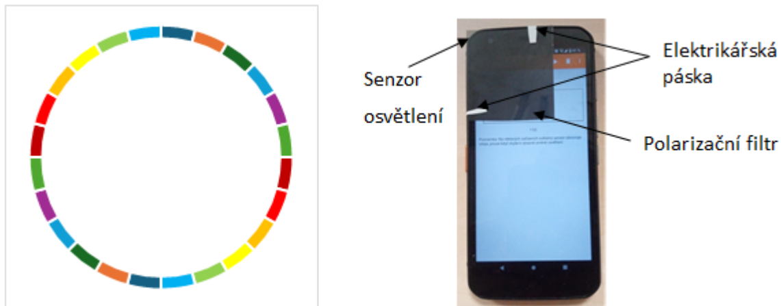
Obr. 8. Kruhový graf zjednodušující polohování mobilního telefonu (otáčení o 15^\circ v jednotlivých krocích) (vlevo), umístění polarizačního filtru na mobilní telefon (vpravo).
