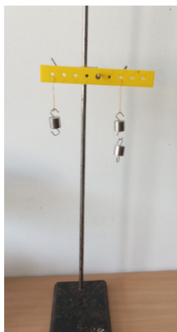
Obr. 3. 3D tištěná páka s otvory pro zavěšení závaží.
