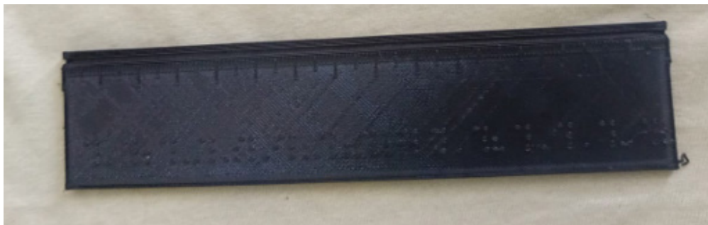
Obr. 1. 3D tištěné pravítko s Braillovým písmem.
