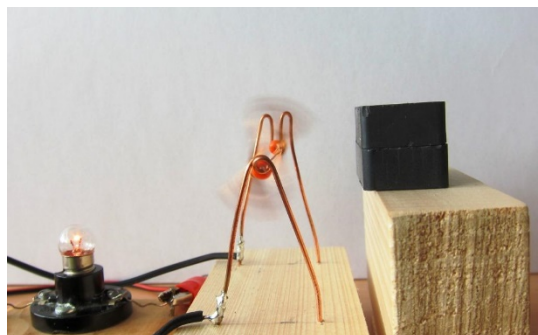
Obr. 8. Magnet může být po straně závitů.
