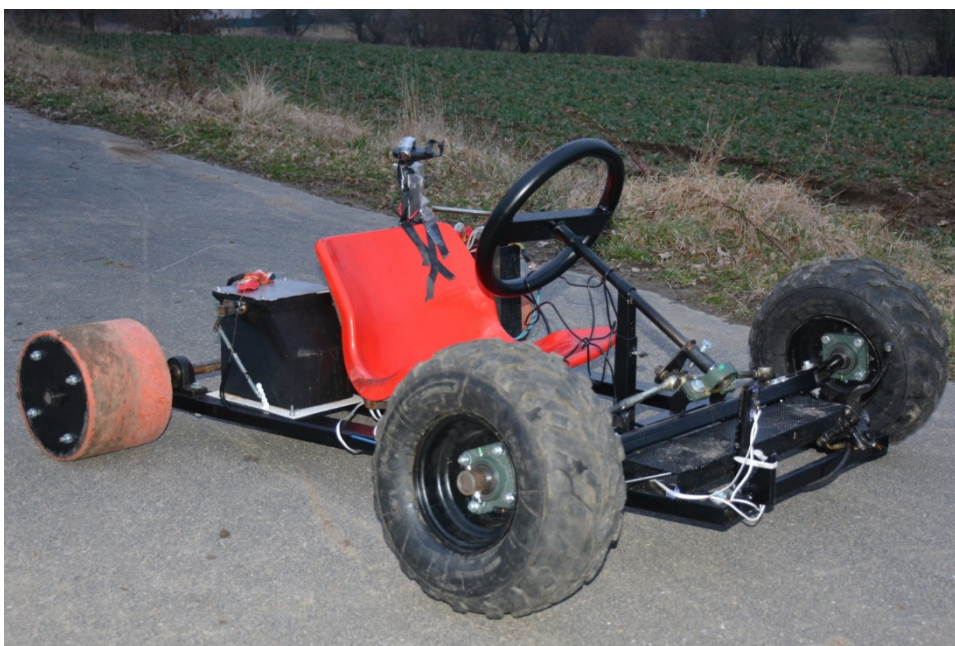
Obr. 3. Elektrická motokára postavená v domácí dílně.
