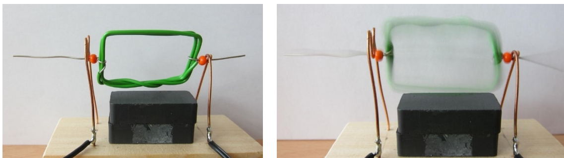
Obr. 13. Motorek, kde obě části osy jsou vodivé ze všech stran.
