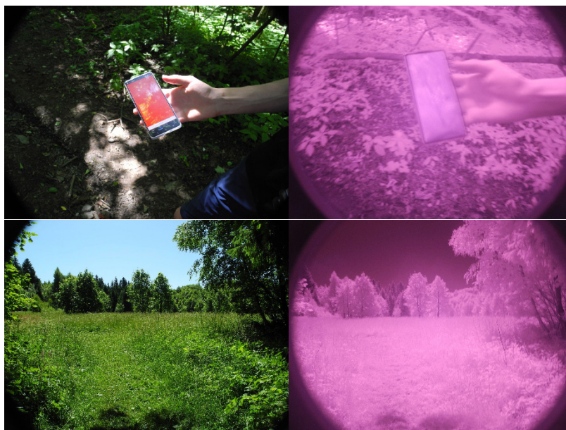
Obr. 3. Srovnání snímků ve viditelném (vlevo) a infračerveném (vpravo) spektru. Zabarvení fotografie do růžova je způsobeno nastavením expozice a clony pro pořízení dostatečně ostrých fotografií.
