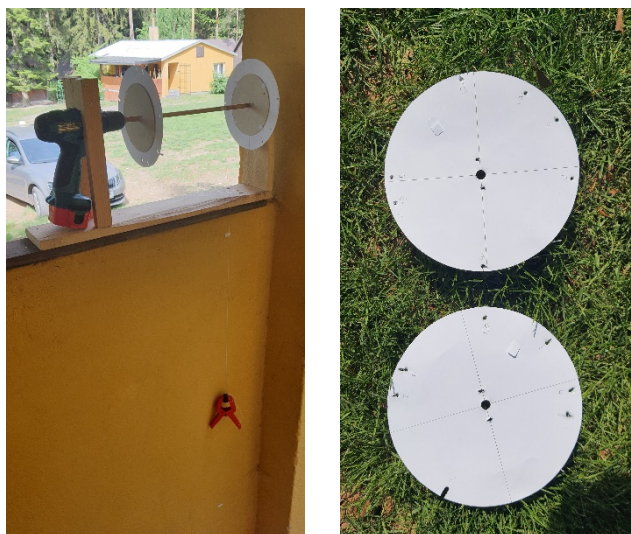
Obr. 8. Měření otáček navíjením nitě a prostřílené kotouče.
