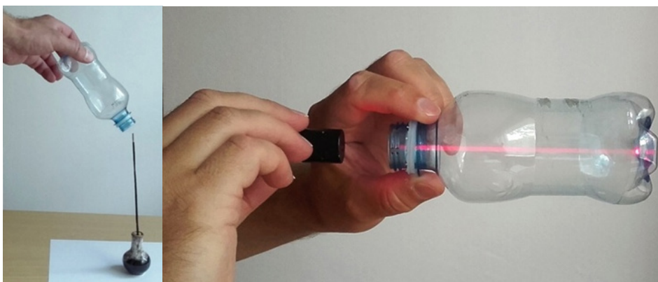
Obr. 12. Zviditelnění paprsku v plastové lahvi naplněné kouřem z vonné tyčinky.
