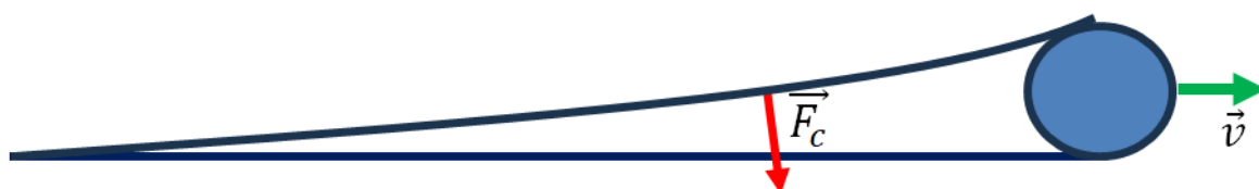
Obr. 2. Jednoduchý model s jedním deformujícím se pravítkem.
