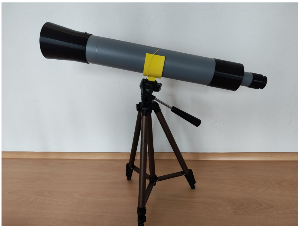
Obr. 2. Sestavený Keplerův dalekohled umístěný ve stativu.
