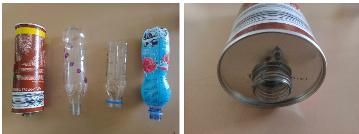
Obr.4. Různé rotory (válec, PET lahve) a detail uchycení válce.
