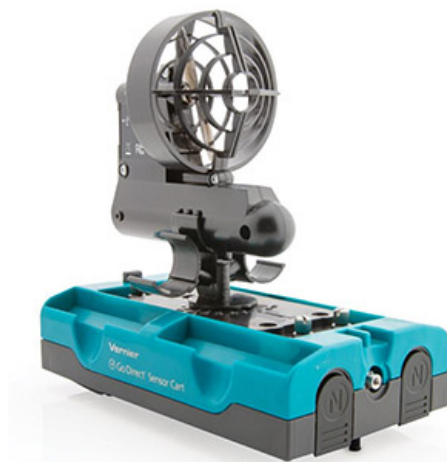
Obr. 1. Vozík s připevněným pohonem Vernier DTS-CFAN.
