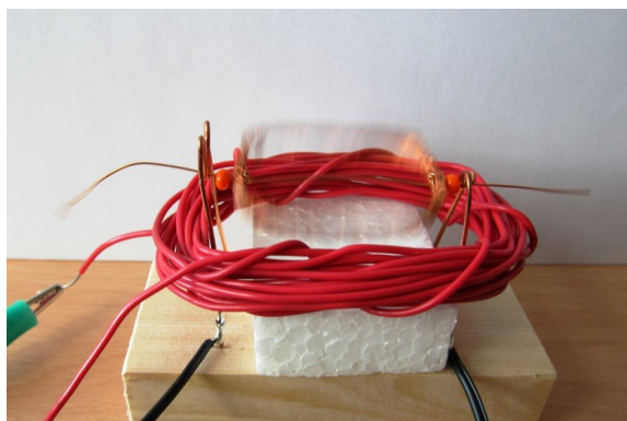
Obr. 12. Motorek s cívkou místo magnetu.
