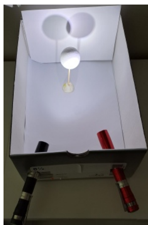
Obr. 10. Plný stín a polostín – uspořádání pokusu v krabici od bot (inspirace: I. Hotová, foto: E. Hejnová).
